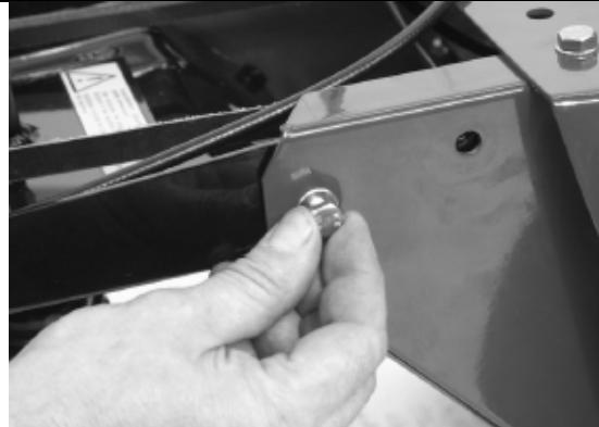
Предварительно смонтировать переднюю часть с помощью незатянутых болтов с шайбами.
