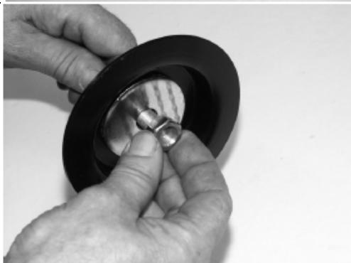
Надеть колпачок и шайбу и закрепить шестигранной гайкой.
