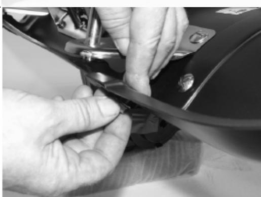
Вставить сверху винты с полукруглой головкой, снизу надеть шайбы и навинтить гайки. Сначала закрутить свободно, потом затянуть.
