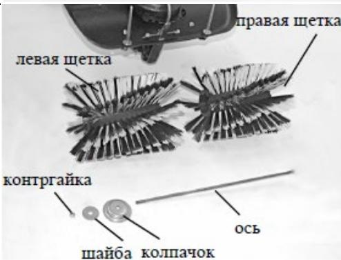
Щетки с монтажными элементами.
