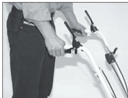
2) Машина будет двигаться назад, пока вы не отпустите рычаг.
