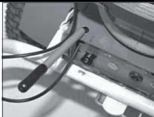
2. Маленькие цифры показывают, какая передача выбрана (здесь вторая)
