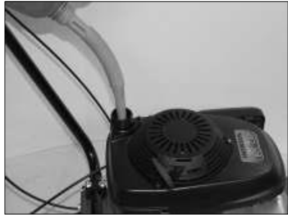
Держите канистру, как показано на рисунке. Заполняйте небольшими количествами, чтобы не перелить топливо.
