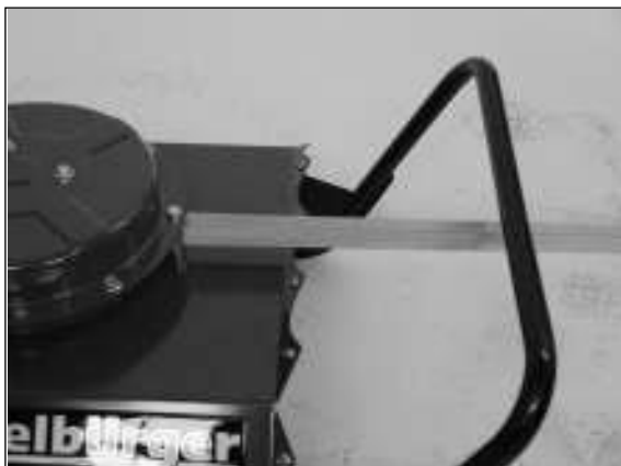
Направляющая натяжного ремня спереди.
