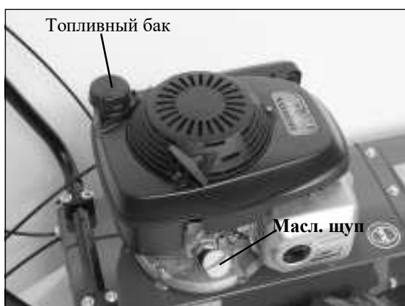
Топливный и масляный баки на двигателе GSV190
