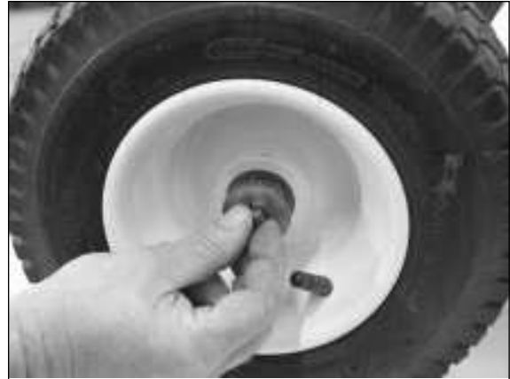
Закрепите винтом с шайбой.
