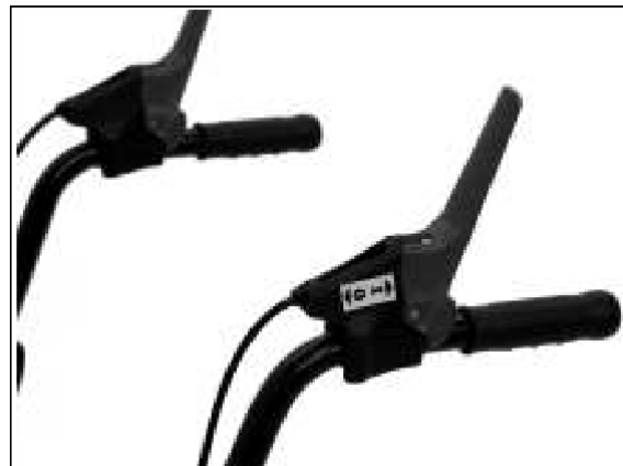
Рычаг привода колес находится в исходном положении.
