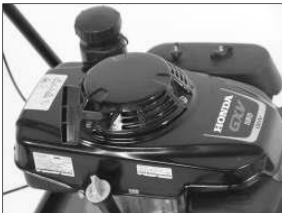
Топливный и масляный баки на двигателе Honda GXV160
