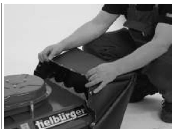
Разместить защитную крышку над полозьями.
