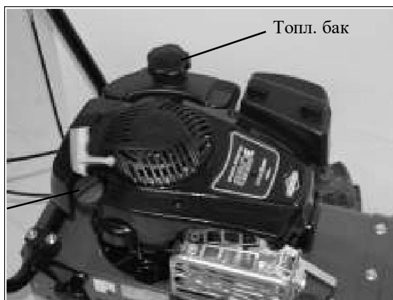
Топливный и масляный баки на двигателе V&S
