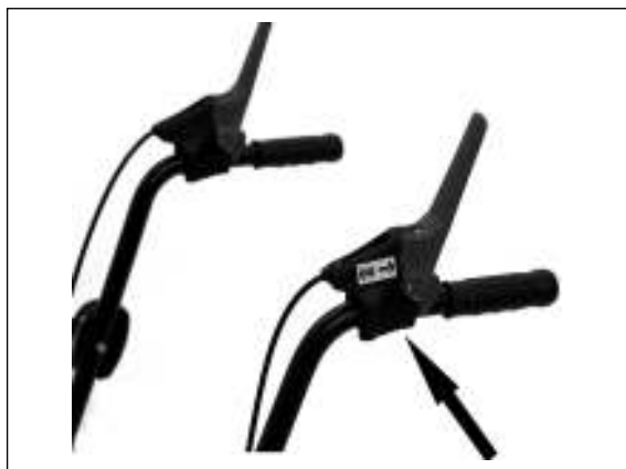
На левой рукоятке находится рычаг привода колес.
