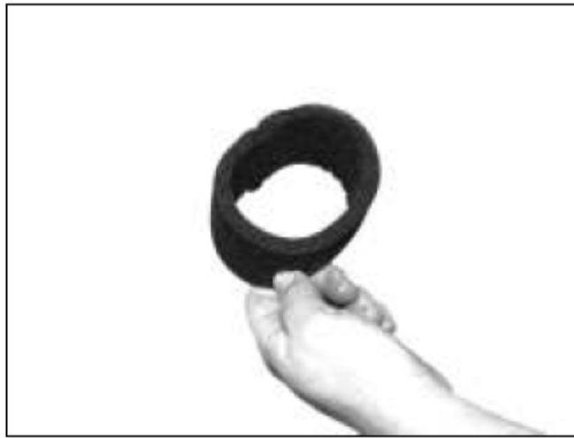
6) Осторожно выбить фильтр грубой очистки или очистить сжатым воздухом
