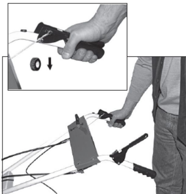
Привод ходовой части включен
